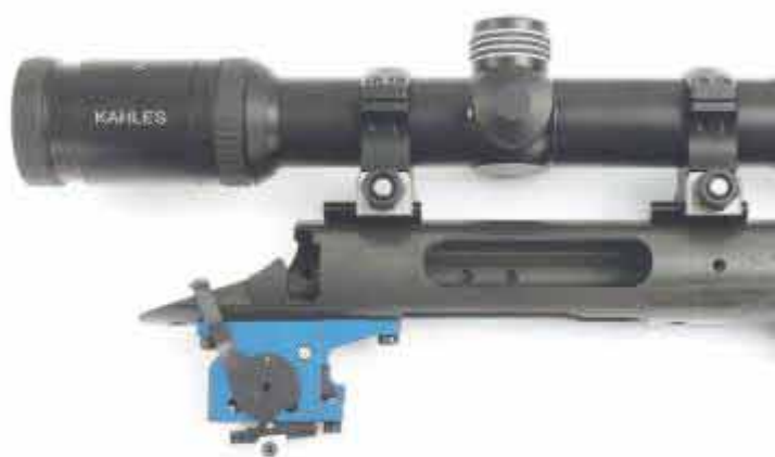
Trycket är fantastiskt för precisionsskytte. Det kan dessutom ställas in för allt utom hårdheten. För oss känns det konstigt att det enda alla andra kan justera går inte att justera på RPA. Hos RPA väljer man mellan 0,5 eller 1,5 kg avtryckarvikt. Sedan kan du justera ingrepp, eftertryck och dessutom hela förtrycket från tryckpunkt till direkttryck med alla steg däremellan. Från att ha varit treksam, jag vill ju alltid ha ungefär 1 kg i avtrycksvikt, får jag nog erkänna att 0,5 kg med tryckpunkt är riktigt bra för precisionsskytte.
