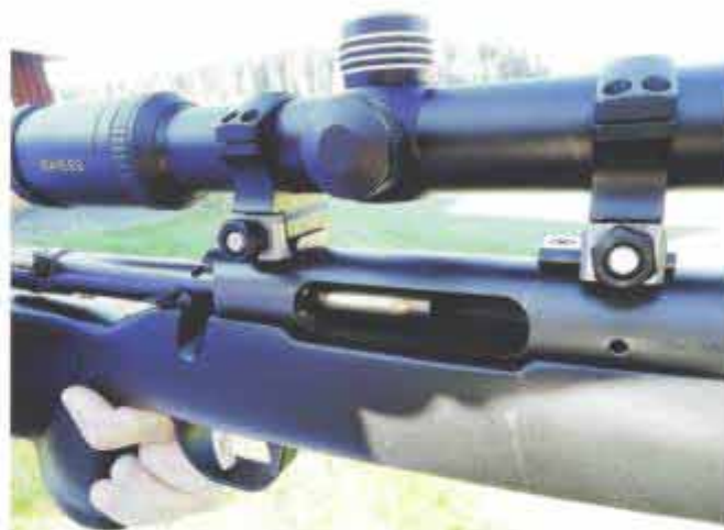
Något var fel med utstötaren. Ibland, som på bilden, blev hylsan kvar i lådan efter repetering. Även när den åkte ut gjorde den det med moderat fart och kraft. Ibland landade hylsan på skjutbänken trots att vi repeterade som på jakt.
